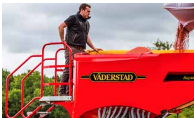
Les Rapid A 400–800S sont désormais équipés d'une plateforme centrale sécurisée, accessible par les deux côtés.
