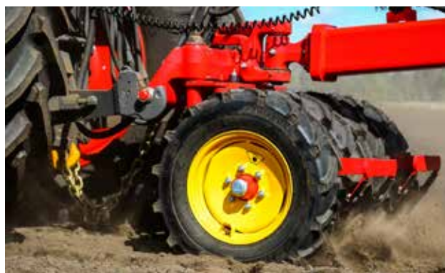
L'option packer pivot consolide le sol entre les roues du tracteur, offrant à chaque semence les mêmes conditions de germination.
