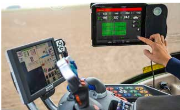
La semence est dosée par deux distributions Fenix III, chacune dosant pour une moitié de machine, ce qui permet de faire la coupe demi-semoir depuis la cabine.
