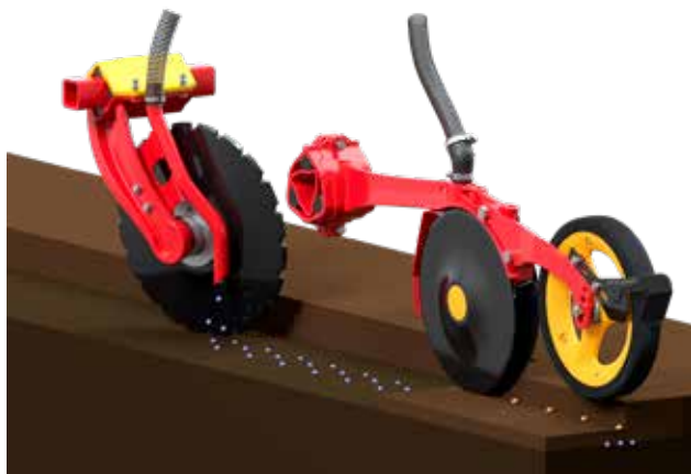
Dans la version FIX, l'engrais est placé en bandes de 5cm de large à un inter-rang de 125mm, devant chaque sillon.
